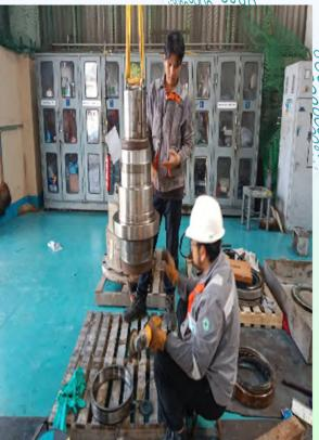
**OVERHAUL GEAR SCREW EXTRUDER UBE**
